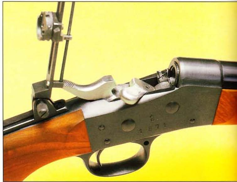
**Blick von rechts auf den Mittelteil der Büchse mit Diopter und geöffnetem Verschluss.**
